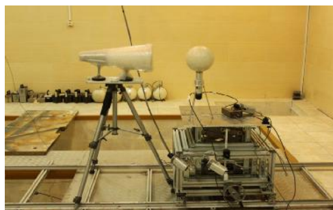
شکل ۱. تصویر چیدمان سامانه طیف‌نگاری کره‌های بانر مجهز به آشکارساز ^6\text{Li(Eu)} و مخروط سایه در آزمایشگاه کالیبره کردن.
