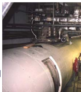
شکل ۵. نمونه واقعی محفظه برهم کنش برای پرتودهی گازهای سمی.
