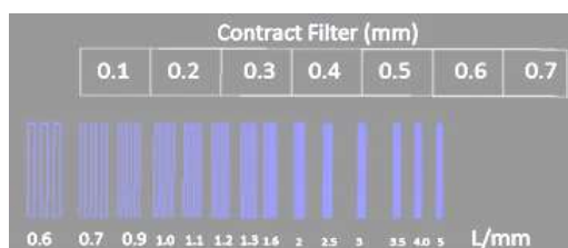
شکل ۲. (رنگی در نسخه الکترونیکی) فانتوم آزمون شیئی طراحی شده برای تعیین کیفیت تصویر خروجی از کد GATE.
