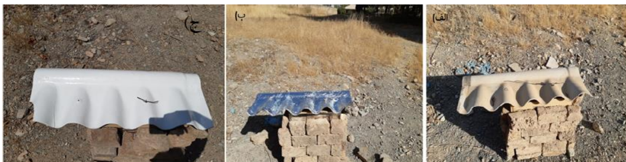
شکل ۶. (الف) اتاقک با سقف ایرانیت ساده، (ب) ایرانیت با برگه آلومینیوم و (ج) ایرانیت با پوشش رنگ روغنی سفید براق.
