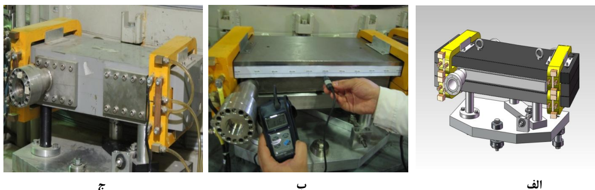
شکل ۳. الف) طرح کلی مگنت، ب) نمونه‌ای از مگنت ساخته شده، ج) مگنت شتاب‌دهنده TT200.
