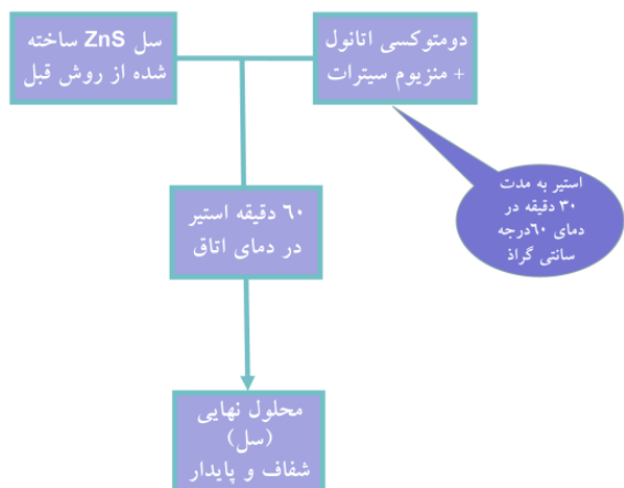
شکل ۲. روش ساخت سل شفاف و پایدار ZnS-Mg.
