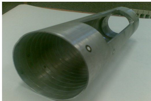
شکل ۲۶. نمونه ساخته شده برای اندازه‌گیری دقت ساخت.
