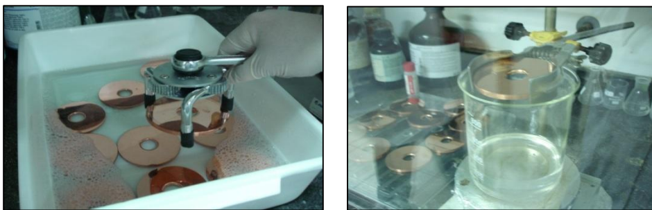
شکل ۹. شستشوی قطعات و قرار دادن آن‌ها در معرض بخار تترا کلرید کربن جهت چربی زدایی.
