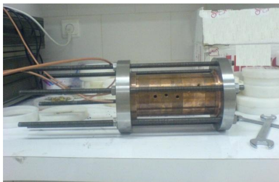
شکل ۵. قطعات ساخته شده کاواک‌های موردنظر و نحوه قرار دادن قطعات در کنار هم.
