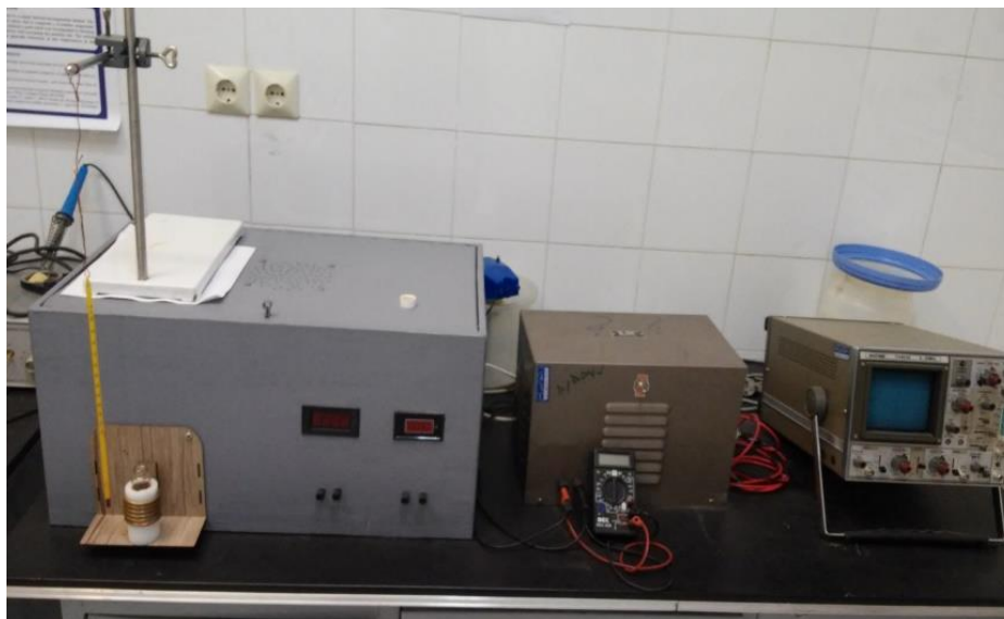
شکل ۲. (رنگی در نسخه الکترونیکی) دستگاه گرمکن القایی ساخته شده در دانشکده فیزیک دانشگاه تبریز جهت انجام آزمایش‌های گرمادرمانی مغناطیسی.
