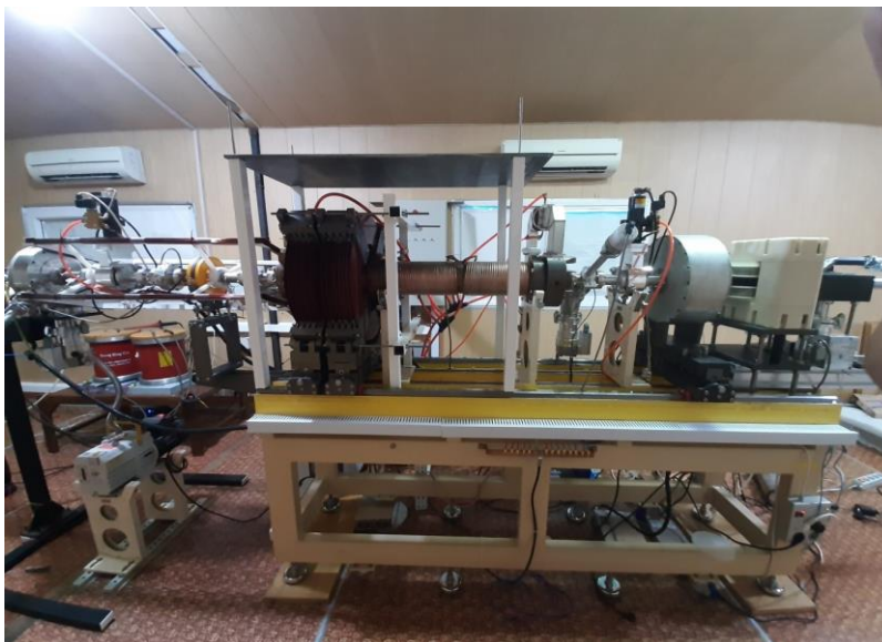
شکل ۶۵. (رنگی در نسخه الکترونیکی) چیدمان فعلی شتابگر خطی پژوهشگاه دانش‌های بنیادی
