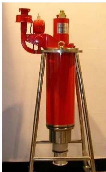
شکل ۴۳. (رنگی در نسخه الکترونیکی) لامپ توپاسترون مدل ۳۷K.
