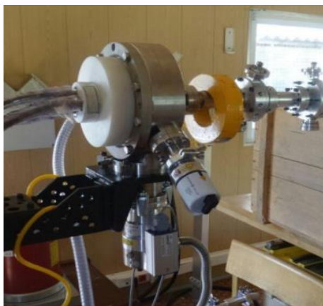
شکل ۳. (رنگی در نسخه الکترونیکی) تفنگ الکترونی پس از نصب برای آزمون‌های اولیه.
