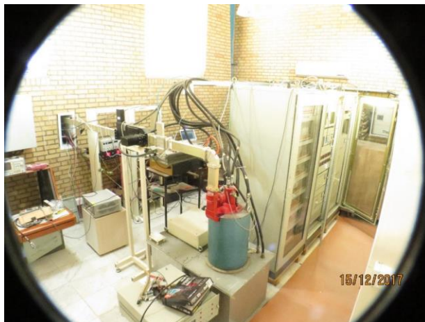
شکل ۴۴. (رنگی در نسخه الکترونیکی) مجموعه تولید توان بالای بسامد رادیویی شتاب‌دهنده خطی (کابینت‌های سمت راست مدولاتور، لامپ به رنگ قرمز، سیملوله کانونی کننده به رنگ آبی و موجرها کاملاً مشخص‌اند).
