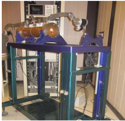
شکل ۴. چیدمان آزمایش اندازه‌گیری اختلالی اسلاتر تیوب.
